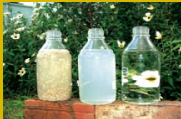
I flasken længst til venstre er der endnu olierester i vandet, men de er siet fra i den midterste flaske. Vandet i flasken til højre har været igennem et siveanlæg, der har gjort vandet langt renere end standarden for europæisk badevand.
